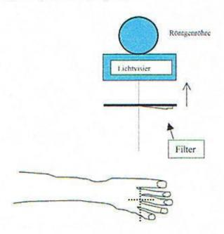
Die Einstellung des Röntgengerätes für Handaufnahmen wie gewohnt vornehmen und bei manueller Belichtung 1 – 2 Punkte stärker belichten.
