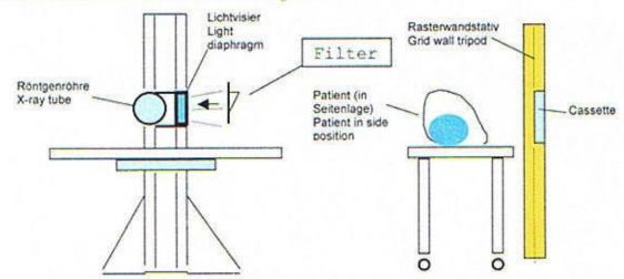
Die Einstellung des Röntgengerätes wie gewohnt vornehmen und Filter so anbringen, daß der dicke Teil des Absorptionskörpers nach oben zeigt.
